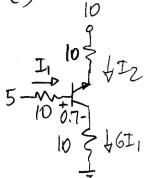
$5 = 10I_1 + 0.7 + 6I_1 \Rightarrow I_1 = 61.4 \mu A$   $I_2 = 5I_1 = 307 \mu A$ ;  $6I_1 = 369 \mu A$ .  $V_B = 5 - 10I_1 = 4.39V$ ;  $V_C = V_B - 0.7$  = 3.69V;  $V_E = 10 - 10I_2 = 6.93V$   $V_{EC} = 6.93 - 3.69 > 0.2V \Rightarrow RA!$
